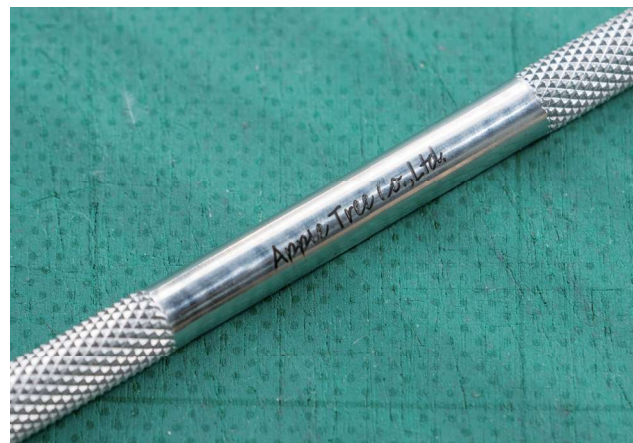
直径5mm金属棒へ社名をマーキングした例
